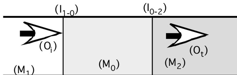
Fig. 6-1 : Onde passant d'un milieu à un autre à travers une couche d'adaptation.
