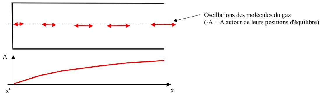
Fig. 6-2 : Oscillation du gaz dans un tuyau fermé à une extrémité et fermé à l'autre : mode fondamental
