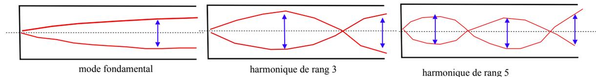
Fig. 6-3 : Premiers modes d'un tuyau ouvert à une extrémité, fermé à l'autre.
