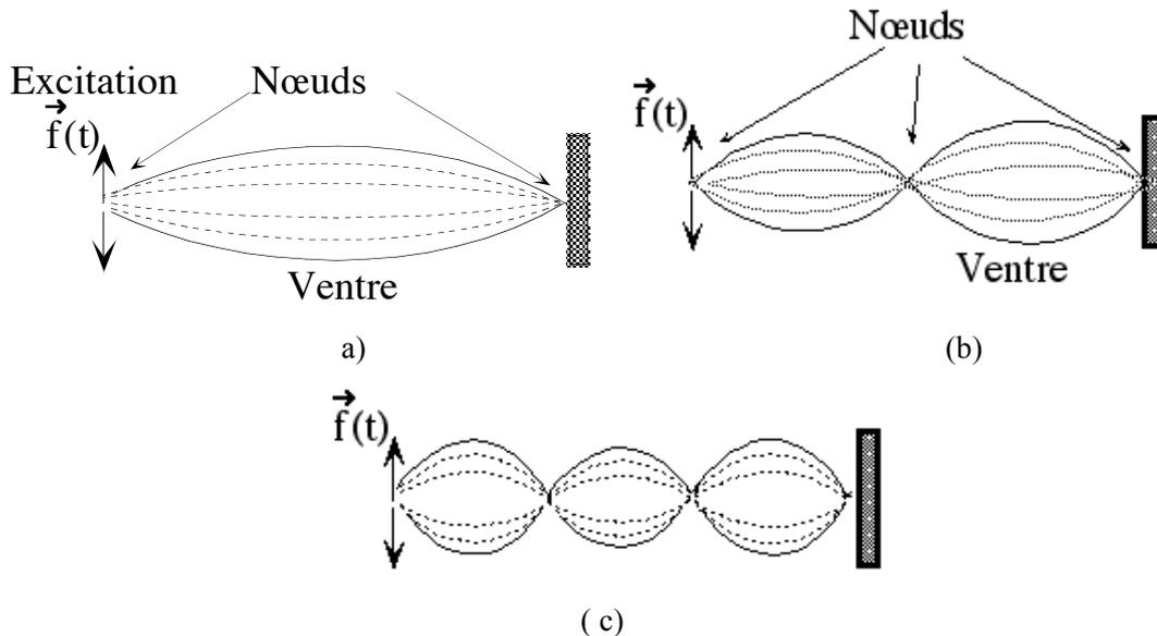
Fig. 6-2 : Ondes stationnaires le long d'une corde de longueur L, excitée aux fréquences de résonance. En pratique, pour faire apparaître les fréquences propres, on peut utiliser une corde fixée aux 2 extrémités et exciter la corde en un endroit quelconque. (a) Fondamentale (ou 1ère harmonique)  $L = \frac{1}{2} \lambda_1$  (b) 2ème harmonique  $L = \lambda_2$  (c) 3ème harmonique  $L = \frac{3}{2} \lambda_3$
