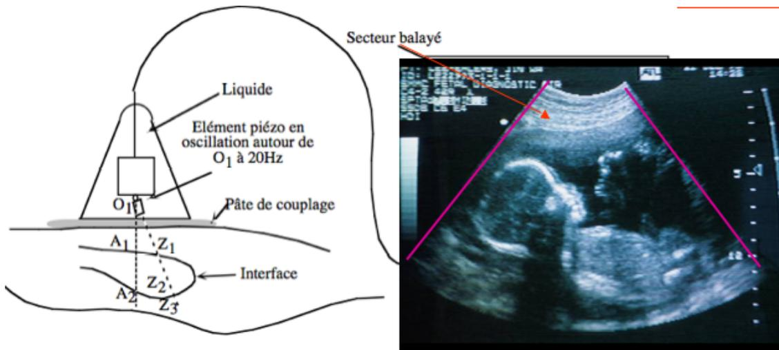
Fig. 6-1 : Schéma d'un dispositif d'échographie médicale par ultrasons. La pâte de couplage permet une bonne transmission des ondes à l'intérieur du corps (adaptation d'impédance).
