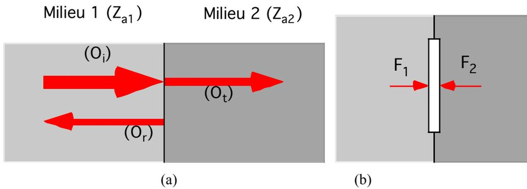
Fig. 6-1 : (a) Réflexion et transmission à une interface entre deux milieux d'impédances différentes. (b) Forces agissant sur une mince couche à l'interface.
