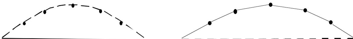
Fig. 4-6 : Mode  $n = 1$  pour  $N = 5$ . (a) Lieu des points de localisation des particules - (b) Forme réelle du système au maximum d'amplitude
