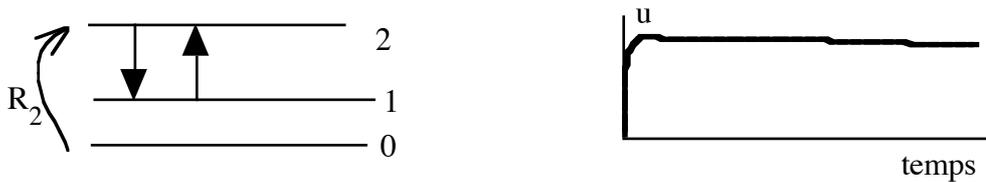
a : Système à trois niveaux pompé par un signal de taux  $R_2$  faisant passer les atomes du niveau 0 au niveau 2 avec une inversion de population possible entre les niveaux 2 et 1.
