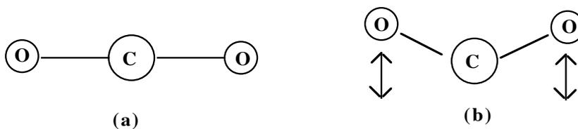
**Fig. 3.1-6 : Énergie d'excitation moléculaire : exemple de la molécule de gaz carbonique**
