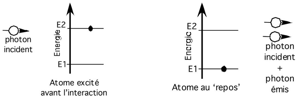
**Fig. 3.1-3 : Émission stimulée (ou induite) : le photon émis a les mêmes propriétés que le photon incident. L'atome retrouve le niveau d'énergie inférieur.**
